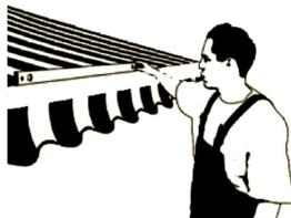
17) Serrez les écrous M22. Fixez les couvercles latéraux et la transmission dans le cas d'un actionneur manuel.
